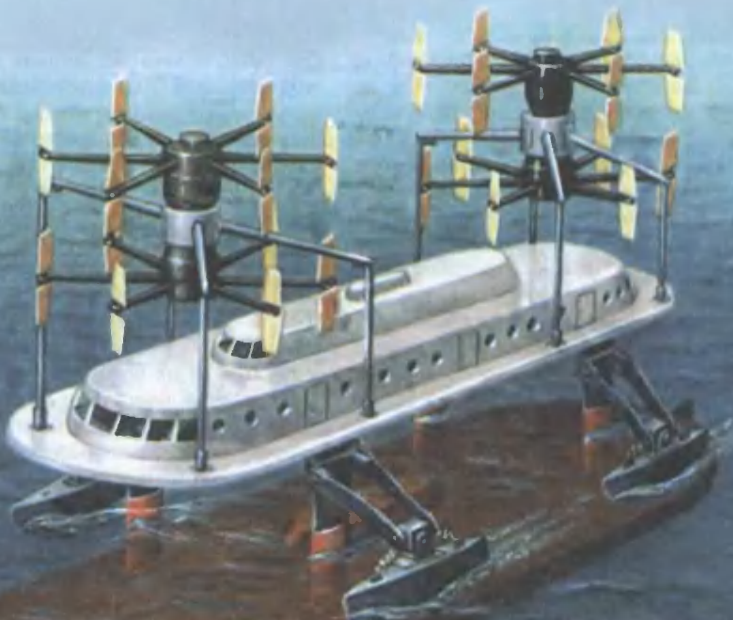
Так выглядит один из возможных вариантов полупогружного судна, использующего энергию и ветра, и волн.
